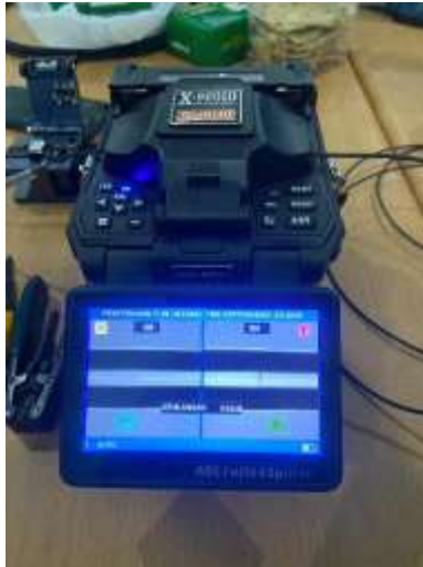
Gambar 4 Proses splicing menggunakan splicer
