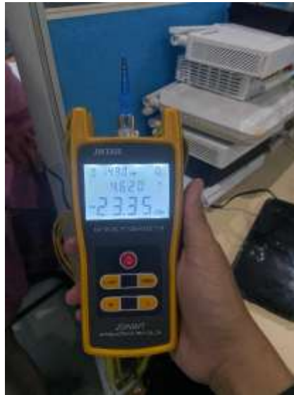
Gambar 6 Pengukuran redaman menggunakan OPM
