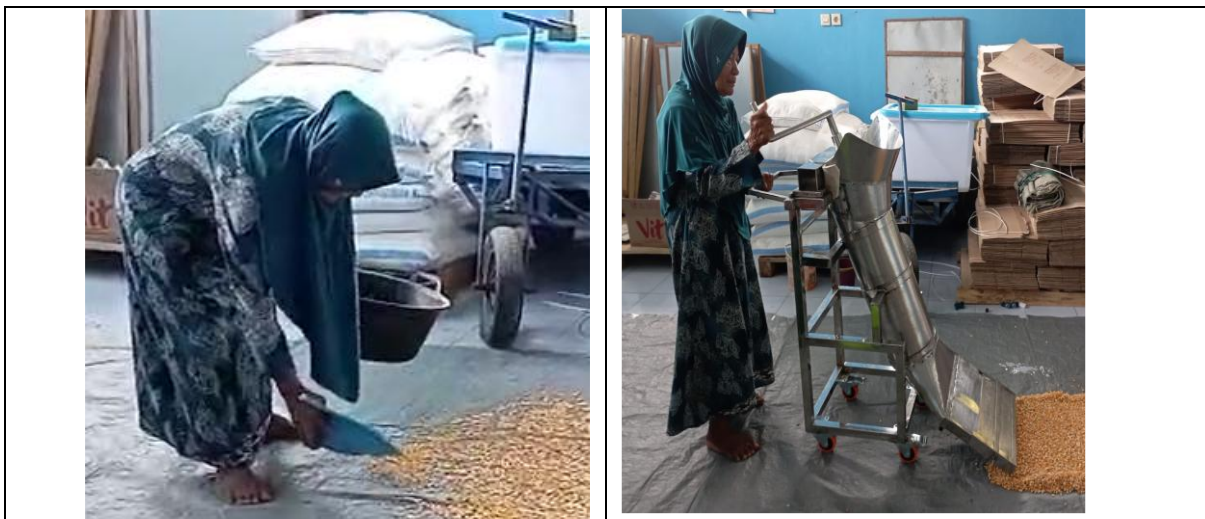
Gambar 2. Proses Implementasi Mesin Penebar dan Perata di Lokasi Mitra
