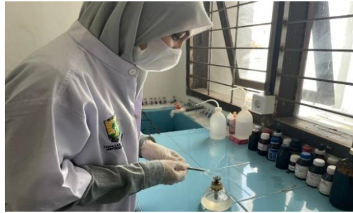
Gambar 5. Slide selanjutnya dipanaskan pada suhu 60C hingga kering
